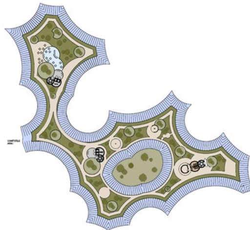
Abb. 7: Dachaufsicht mit Photovoltaik-Paneelen [Architekten M. Thesing, P. Böhm]
